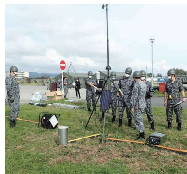
移動気象器材の展開。移動式気象観測器材のTACMET-Rから、風向風速、気温、湿度、気圧、雲の高さ等の気象情報を観測する気象特技の隊員たち
