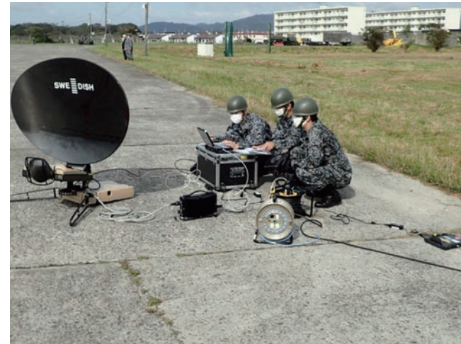
可搬型衛星通信装置で通信回線を構成することにより展開地においてパソコン等を使用した情報のやり取りが可能となる。
