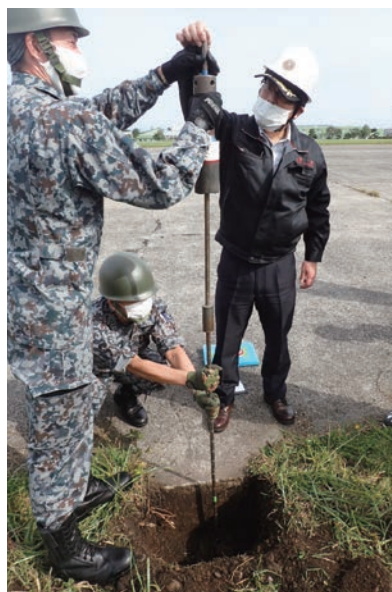
DCP（Dynamic Cone Penetrometer）内部部局の施設整備調査チームによる滑走路健全性確認の様子。重車両による滑走路強度調査を実施する隊員
