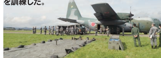
C-130Hからブラダータンクへ燃料を移送する訓練
