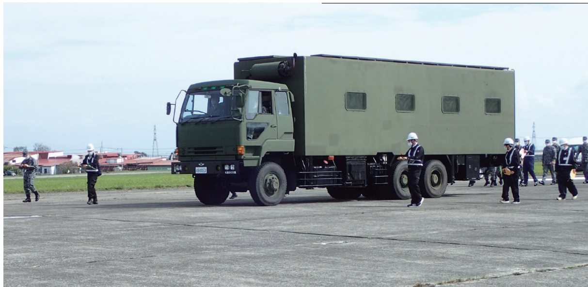
内部部局の施設整備調査チームによる滑走路健全性確認の様子。重車両をゆっくりと滑走路を走らせ、目視により滑走路面のたわみを確認する。
